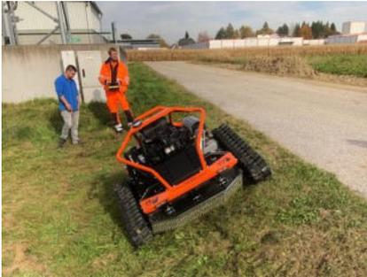
Der ferngesteuerte hydraulische Sichelmulcher wurde zur Unterstützung und effizienteren Erledigung der Arbeiten des Bauhofes bei der Pflege der Grünflächen angekauft. Der Mulcher ist in Hanglagen bis zu 55° einsetzbar und daher auch für das Mähen von Sickerbecken und Böschungen, z.B. bei Bächen, geeignet.
